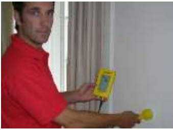
Vochtmeting vooraf met behulp van microgolven meetapparatuur
