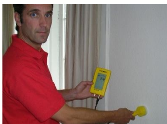
Vochtmeting vooraf met behulp van microgolven meetapparatuur
